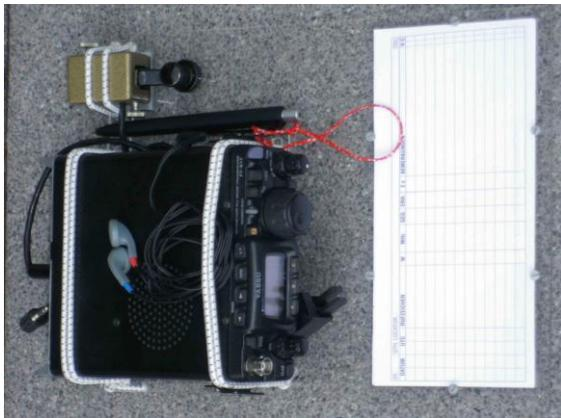
Für den FT-817 werden zwei Spannhaltungen angebracht. Die kleine Hubmorse-Taste wird nur mit einem doppelten Gummizug - auch an so einer Lasche befestigt. Zum Lösen drückt man von der Unterseite nur den umgelgten Gummizug von der Lasche - und schon sind die Geräte wieder lose für einen anderen Einsatzbereich - frei.
