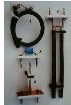
Abb. 6: links: Aufsteckbare Glimmlampen als Abstimhilfen. Links rot, rechts blau (aus dem Starter einer Leuchtstoffröhre) Mitte: Magnetantenne B, nachgerüstet mit Getriebemotor und Pulsbreitensteuerung zur Fernabstimmung rechts: Modell B: Verschiedene steckbare Zusatz-Cs
