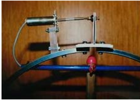
Abb. 6: links: Aufsteckbare Glimmlampen als Abstimmhilfen. Links rot, rechts blau (aus dem Starter einer Leuchtstoffröhre) Mitte: Magnetantenne B, nachgerüstet mit Getriebemotor und Pulsbreitensteuerung zur Fernabstimmung rechts: Modell B: Verschiedene steckbare Zusatz-Cs
