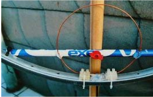
Abb. 5: links: Modell B: Halterung sowie Einspeisung über Lüsterklemmen rechts: Die Einspeisung mit einem Eisenpulverkern brachte beim Verfasser deutlich schlechtere Ergebnisse als mit einem Speisering
