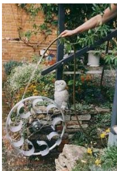
Abb. 1: Aus PVC-Dachrinne bestehen die neun „Schaufeln“ für ein Spielerei-Wasserrad mit 3-W-Dynamo
