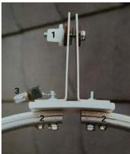
Abb. 2: Modell A: 1 = C-Variation über die Änderung des Plattenabstandes d, 2 = Buchsen für steckbare Zusatz-Cs, 3 = Glimmlampe als Abstimmhilfe
