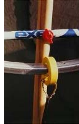
Abb. 5: links: Modell B: Halterung sowie Einspeisung über Lüsterklemmen rechts: Die Einspeisung mit einem Eisenpulverkern brachte beim Verfasser deutlich schlechtere Ergebnisse als mit einem Speisering
