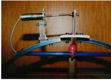
Abb. 6: links: Aufsteckbare Glimmlampen als Abstimhilfen. Links rot, rechts blau (aus dem Starter einer Leuchtstoffröhre) Mitte: Magnetantenne B, nachgerüstet mit Getriebemotor und Pulsbreitensteuerung zur Fernabstimmung rechts: Modell B: Verschiedene steckbare Zusatz-Cs
