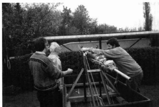
Z45-Funkanhänger mit Kurbelmast, Rotoren und Platz für die 2-m- und 70-cm-Antennen. In einer Stunde erledigen DL1ECS, DL8DBI und DD2ER (v.l.n.r.) den Aufbau.
