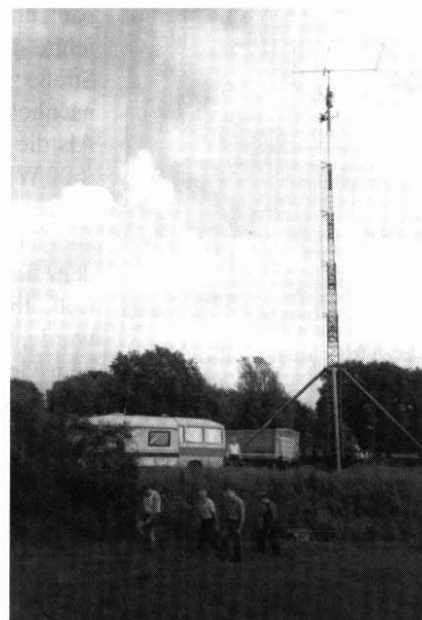
1997 beim FD in Bremen-Nord: 3-Band-KW-Beam auf einem 25-m-Mobilmast.
